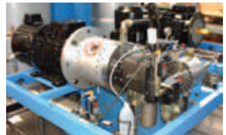
Wartungsfreie Abdichtung von Dosierpumpen für Polyol und Isocyanat in Hochdruck-Reaktionsgießmaschinen
