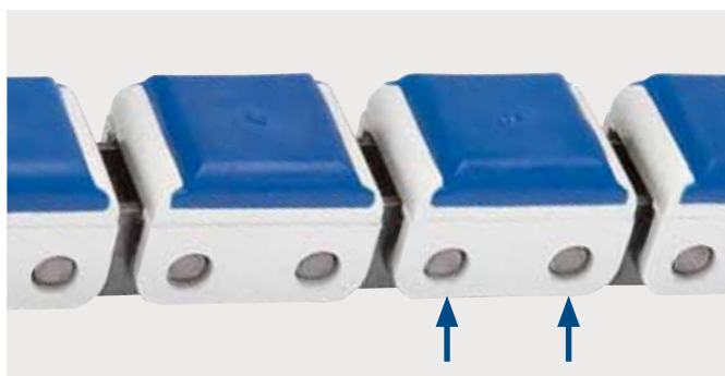
Fixierung der Clips über die Bolzenüberstände, vorzugsweise mit ungenieteten Ketten oder verlängerten Bolzen
